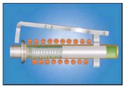
В процессе этого движения, рабочая жидкость регулирует скорость движения сердечника, таким образом, создавая контролируемую задержку, длительность которой обратно пропорциональна силе тока. Эта задержка
