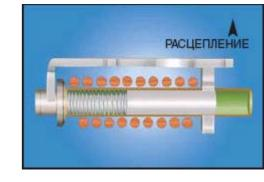
цепи значительно снижается и, таким образом, якорь притягивается к полюсному наконечнику с силой, которой достаточно для обеспечения срабатывания механизма защелки (переключателя) и, в результате, автоматический выключатель расцепляется. Контакты размыкаются, ток прекращается, и сердечник возвращается в исходное положение.
