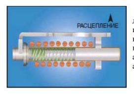
При больших значениях перегрузок или при коротком замыкании, магнитный поток, создаваемый катушкой, достаточен для обеспечения притяжения якоря к полюсному наконечнику и расцепления автоматического выключателя, хотя сердечник и не сдвигается с места. Этот параметр называется зоной мгновенного расцепления автоматического выключателя. В отличие от тепловых автоматических выключателей, точка расцепления
